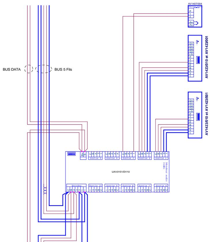
**!** Passer le câble du bus BUS+ et BUS- sur une paire SYT 0,6 mm<sup>2</sup> séparée du reste des fils et de l'alternatif, et loin de tout courant fort.
